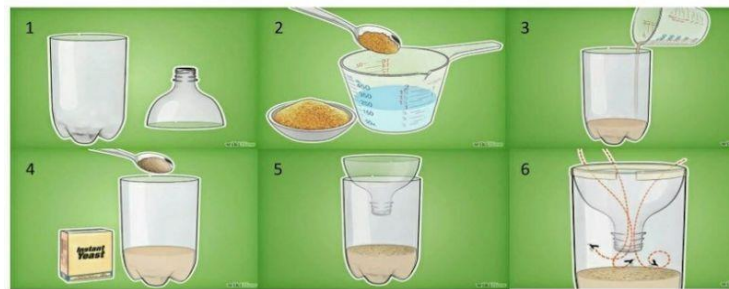
Gambar 2: Langkah-langkah pembuatan teknologi tepat guna alat pembasmi nyamuk
